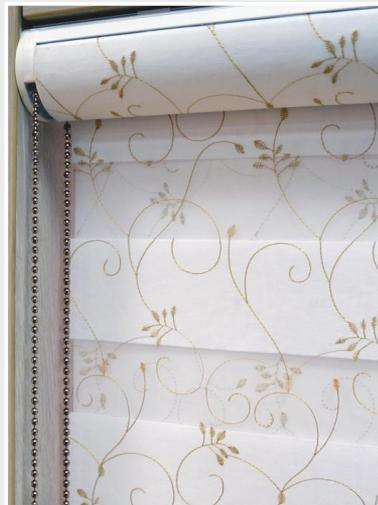
При использовании цепей-петель, удобно то, что мы не ограничены высотой управления. Замкнутая цепь-петля может несколько раз проходить сквозь механизм, позволяя управлять изделием любой высоты. В данном случае ограничители цепи не устанавливаются, верхнее и нижнее положения полотна изделия ничем не ограничены. Рекомендуем предупреждать об этом конечного клиента.
